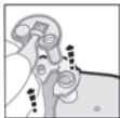
Fig. 1 Quite la tapa de cierre Introduzca el cartucho en el aparato mezclador
